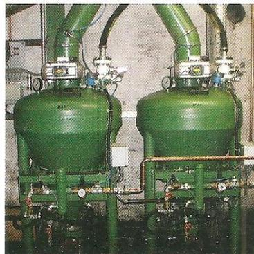
Bild 6. 2 Staubsender unter dem Zyklon
